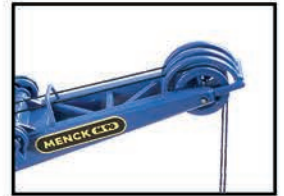
03. die Greifer-Seile (1) und (3) über den Rollenkopf führen
